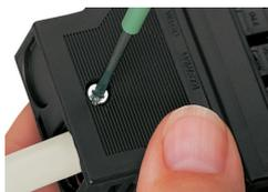
Stringere la vite del dispositivo antistrappo usando un cacciavite.
