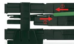
Tutte le connessioni dei connettori di distribuzione sono bloccate e protette dalla disinserzione accidentale subito dopo la giunzione. Con un cacciavite è possibile rilasciare il bloccaggio di una qualsiasi connessione anche se tutte le connessioni sono utilizzate.
