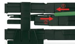
Tutte le connessioni dei connettori di distribuzione sono bloccate e protette dalla disinserizione accidentale subito dopo la giunzione. Con un cacciavite è possibile rilasciare il bloccaggio di una qualsiasi connessione anche se tutte le connessioni sono utilizzate.
