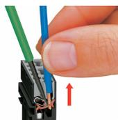
Per rimuovere il conduttore, sbloccare la morsa con il cacciavite (larghezza lama di 2,5 mm) ed estrarre il conduttore.
