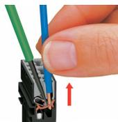
Per rimuovere il conduttore, sbloccare la morsa con il cacciavite (larghezza lama di 2,5 mm) ed estrarre il conduttore.
