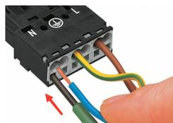
Per collegare i conduttori flessibili, aprire la morsa di contatto con il cacciavite (larghezza lama di 2,5 mm) e inserire un conduttore spelato fino in fondo.
