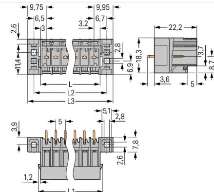
$L_1 = L + 2,4 \text{ mm}$ ,  $L_2 = L + 7 \text{ mm}$ ,  $L_3 = L + 13,5 \text{ mm}$
