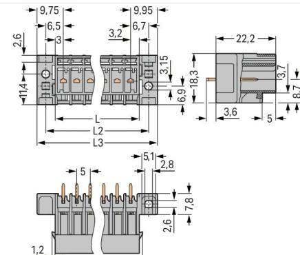
L1 = L + 2,4 mm, L2 = L + 7 mm, L3 = L + 13,5 mm
