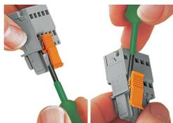
Bloccaggio/rilascio di una leva.
