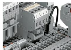
Ponticellamento di una spina femmina per 2 conduttori tramite ponticello a passo e morsetti di base tramite ponticelli orizzontali.
