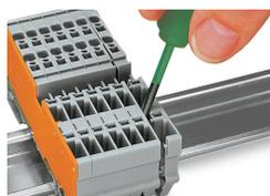
Aprire il gruppo facendo scorrere lateralmente un blocco usando l'utensile e rimuovere il morsetto mediante la leva di rilascio.
