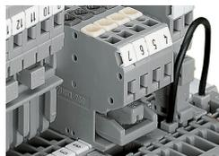
Possibilità di messa in comune dei connettori femmina: Dopo la rimozione, i potenziali ponticellati restano in comune. Utilizzo di ponticelli a innesto invece di ponticelli a filo supplementari. Impiegabile con una chiave "hardware" per bloccaggio di sicurezza. Utilizzabile anche come un ponticello di messa in comune per circuiti di sensori o programmazione macchine.
