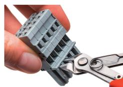
Codifica di un connettore femmina rimuovendo il (o i) perno(i) di codifica tramite utensile di taglio. Non rimuovere il primo e l'ultimo perno di codifica oppure utilizzare una leva di bloccaggio aggiuntiva.
