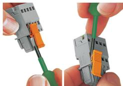
Bloccaggio/rilascio di una leva.
