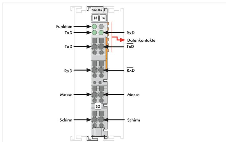
L'interfaccia seriale del modulo I/O si connette ai dispositivi con interfaccia RS-485.
