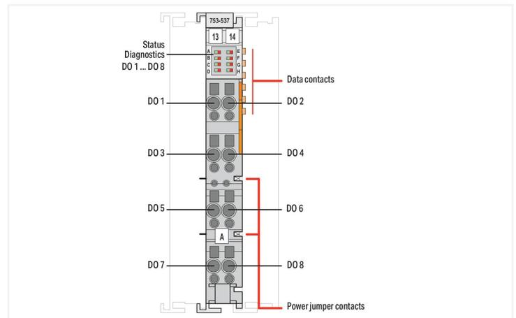
Questo modulo d'uscita digitale trasmette i segnali di comando dal dispositivo d'automazione agli attuatori collegati. Tutte le uscite sono protette contro il cortocircuito. Il modulo rileva i seguenti errori: sovraccarico, cortocircuito e interruzione linea. Lo stato è trasmesso all'accoppiatore del fieldbus e indicato da LED. Questo modulo possiede otto canali d'uscita e al modulo possono essere connessi otto attuatori. Campo e sistema sono separati galvanicamente.
