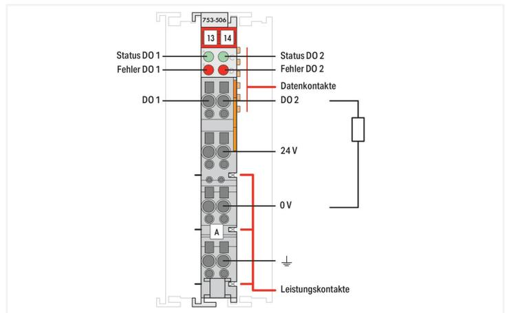
Questo modulo d'uscita digitale trasmette i segnali di comando dal dispositivo d'automazione agli attuatori collegati. Tutte le uscite sono protette contro il cortocircuito. Il modulo rileva i seguenti errori: sovraccarico, cortocircuito e interruzione linea. Lo stato è trasmesso all'accoppiatore del fieldbus e indicato da LED. Campo e sistema sono separati galvanicamente.
