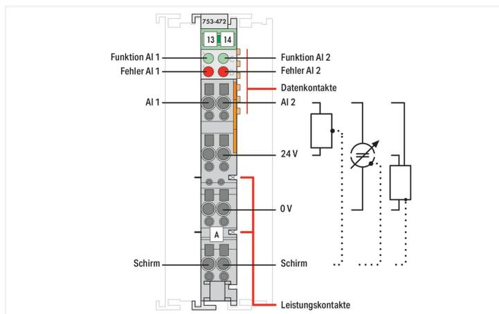
Questo modulo d'ingresso analogico alimenta i convertitori di segnale lato campo e trasmette i segnali analogici isolati elettronicamente al sistema bus. L'alimentazione a 24 V lato campo è fornita dai contatti per ponticello di potenza del modulo.
