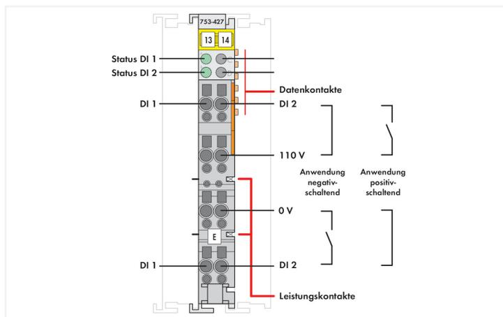
Questo modulo di ingresso digitale riceve i segnali di controllo dai dispositivi sul campo (ad es. sensori). Il modulo dispone di due canali. Ogni canale può essere usato come un ingresso per la commutazione del positivo o del negativo. Campo e sistema sono separati galvanicamente.
