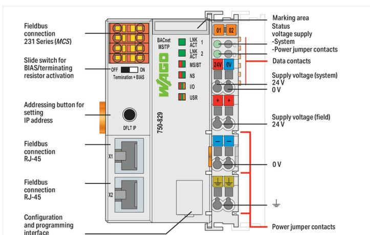
Il controllore BACnet MS/TP (750-829) connette il WAGO-I/O System al protocollo BACnet e supporta il profilo del dispositivo BACnet B-BC secondo DIN EN ISO 16484-5. Il dispositivo comunica con gli altri dispositivi BACnet attraverso BACnet MS/TP.
