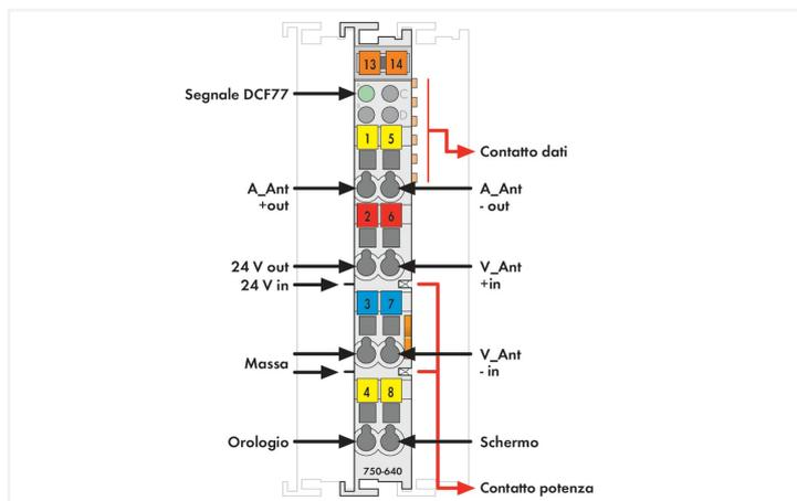
Il modulo RTC 750-640 fornisce il tempo effettivo al sistema di controllo sovraordinato.
