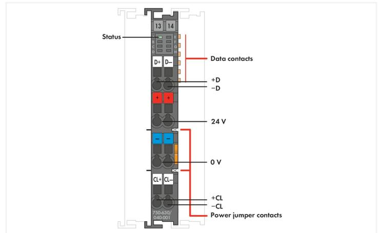
Questo modulo è un'interfaccia SSI per il collegamento diretto a un trasmettitore SSI. Dopo che il modulo ha emesso un impulso di clock al sensore, il modulo legge i dati in entrata e li trasmette direttamente come formato di dati word nell'immagine di processo del PC o del PLC. Le diverse modalità operative, le frequenze di trasmissione e la larghezza dei bit sono regolabili per mezzo del registro di comando.
