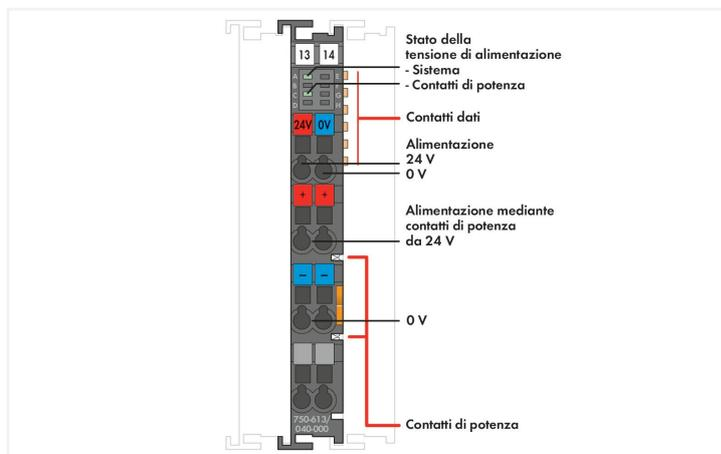
Questo modulo d'alimentazione del sistema interno aumenta la capacità del sistema d'alimentazione con 2 A per i nodi fieldbus con elevate richieste energetiche (somma del consumo di corrente interno dei moduli I/O).
