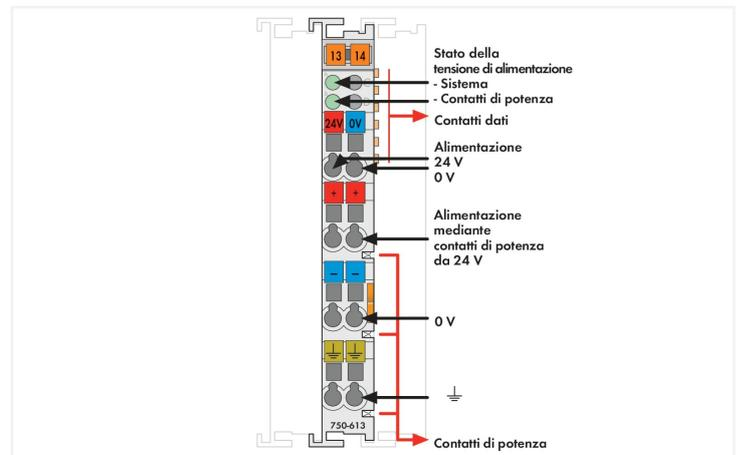
Questo modulo d'alimentazione del sistema interno aumenta la capacità del sistema d'alimentazione con 2 A per i nodi fieldbus con elevate richieste energetiche (somma del consumo di corrente interno dei moduli I/O).
