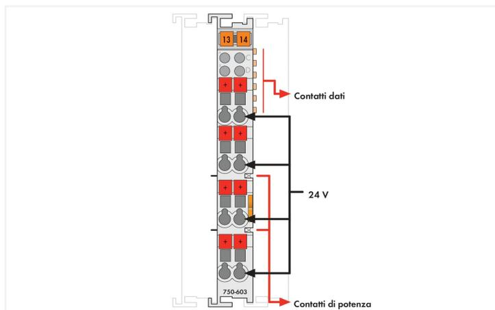
Il modulo di connessione lato campo offre una derivazione multipla dell'alimentazione di tensione.
