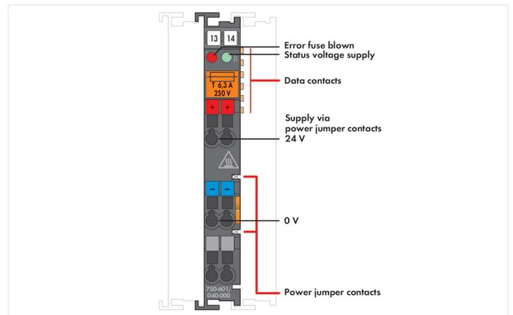
Questo modulo di alimentazione fornisce il potenziale del lato campo tramite i contatti di potenza.
