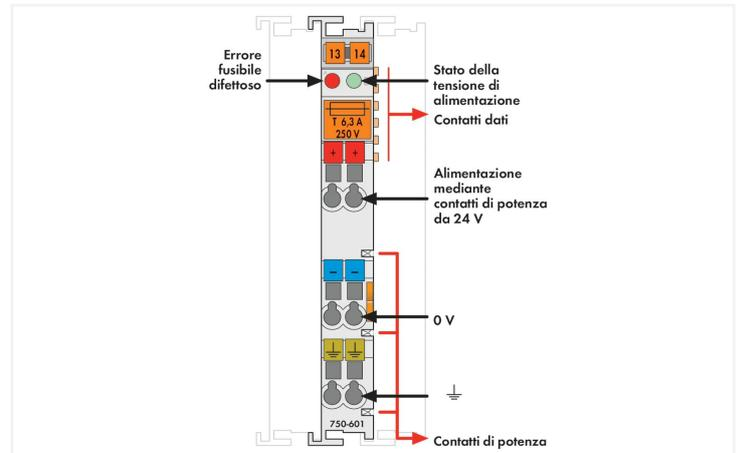
Questo modulo di alimentazione fornisce il relativo potenziale di alimentazione ai moduli I/O.
