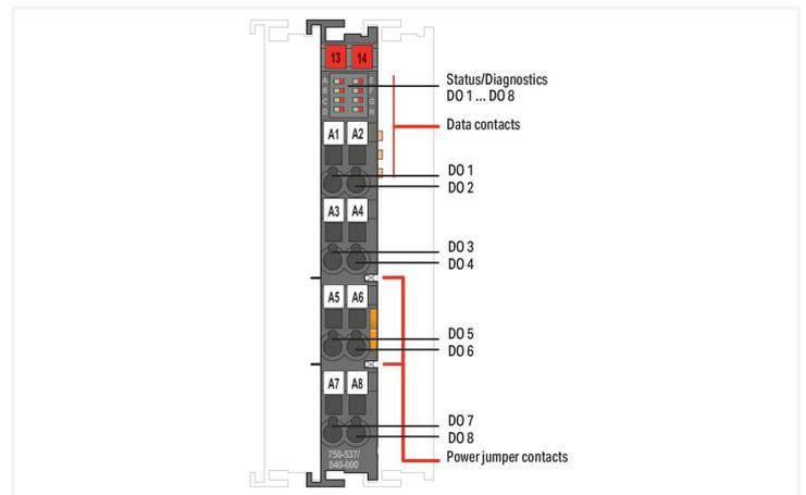
Questo modulo d'uscita digitale trasmette i segnali di comando dal dispositivo d'automazione agli attuatori collegati. Tutte le uscite sono protette contro il cortocircuito. Il modulo rileva i seguenti errori: sovraccarico, cortocircuito e interruzione linea. Stato e diagnostica sono segnalati tramite LED. Questo modulo possiede otto canali d'uscita e al modulo possono essere connessi otto attuatori. Campo e sistema sono separati galvanicamente.
