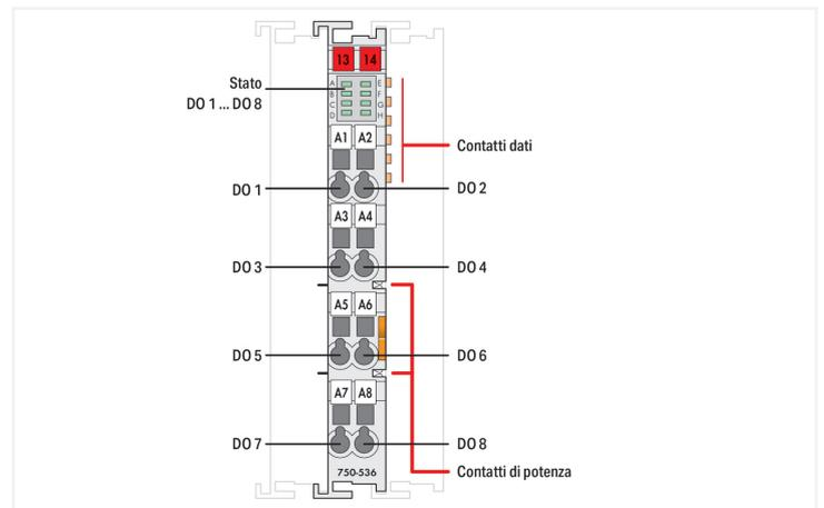
Questo modulo d'uscita digitale dispone di otto canali in una larghezza di soli 12 mm (0,47 poll.). Il modulo trasmette i segnali di comando dal dispositivo di automazione agli attuatori collegati. Tutte le uscite sono protette contro il cortocircuito. Campo e sistema sono separati galvanicamente.
