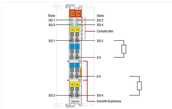
Questo modulo d'uscita digitale trasmette i segnali di comando dal dispositivo d'automazione agli attuatori collegati. Il modulo dispone di quattro canali d'uscita e quattro uscite da 0 V, offrendo una connessione diretta a quattro attuatori a 2 cavi. Tutte le uscite sono protette contro il cortocircuito. Campo e sistema sono separati galvanicamente.
