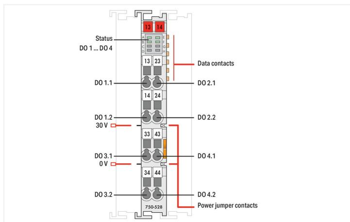
Questo modulo d'uscita digitale trasmette i segnali di comando da un dispositivo d'automazione agli attuatori collegati.
