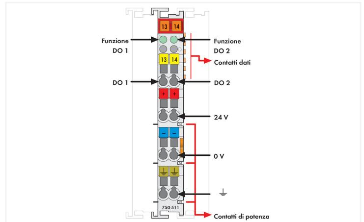
Questo modulo d'uscita esegue la modulazione di un'informazione a 16 bit nella larghezza dell'impulso. Il lato campo è isolato galvanicamente dal sistema bus.
