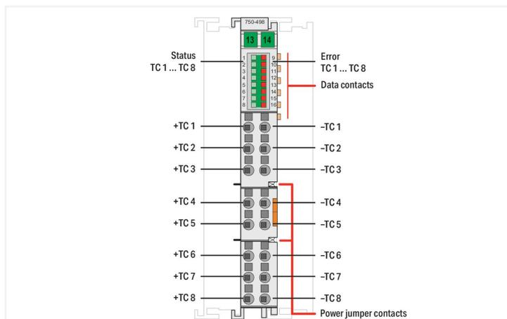
Il modulo I/O 750-498 misura le tensioni (mV) nel campo o analizza le termocoppie.
