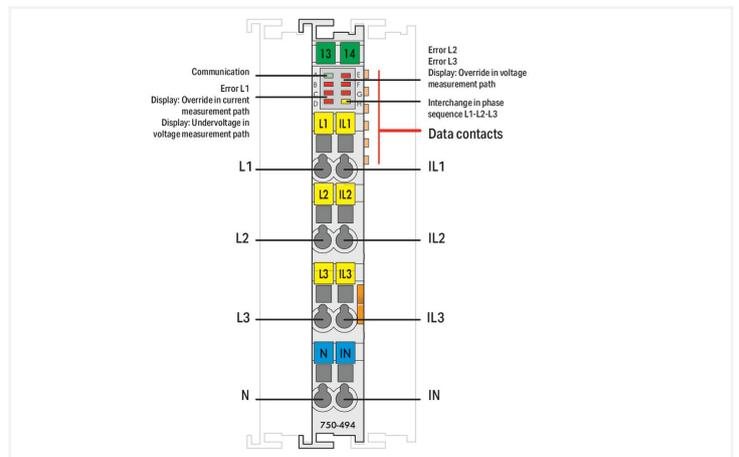
Il modulo di misurazione della potenza trifase 750-494 misura i dati elettrici in una rete di alimentazione trifase.
