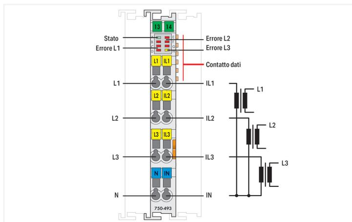
Il modulo di misurazione della potenza trifase misura i dati elettrici in una rete di alimentazione trifase.
