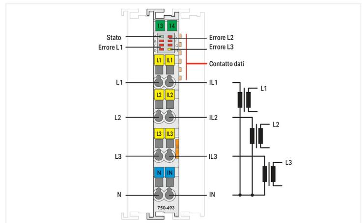
Il modulo di misurazione della potenza trifase 750-493 misura i dati elettrici in una rete di alimentazione trifase.
