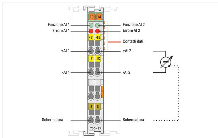
Questo modulo d'ingresso analogico elabora i segnali differenziali nel campo da 0 a 30 V DC. Il segnale d'ingresso di ciascun canale è isolato galvanicamente ed è trasmesso con una risoluzione di 14 bit. L'alimentazione di sistema fornisce alimentazione al modulo. La schermatura si collega direttamente alla guida DIN.
