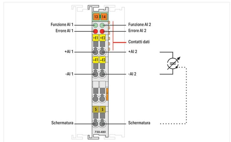
Questo modulo d'ingresso analogico a 2 canali elabora i segnali differenziali nel campo da 0 a 20 mA. Il segnale d'ingresso di ciascun canale è isolato galvanicamente ed è trasmesso con una risoluzione di 13 bit. L'alimentazione di sistema fornisce alimentazione al modulo. La schermatura si collega direttamente alla guida DIN.
