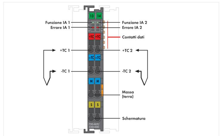
Questo modulo d'ingresso analogico si collega direttamente a due termocoppie. L'isolamento elettrico interno consente il funzionamento di sensori con messa a terra.
