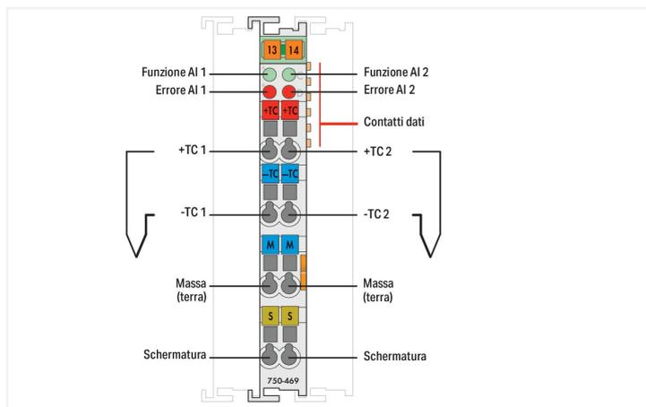
Questo modulo d'ingresso analogico si collega direttamente a due termocoppie. L'isolamento elettrico interno consente il funzionamento di sensori con messa a terra.
