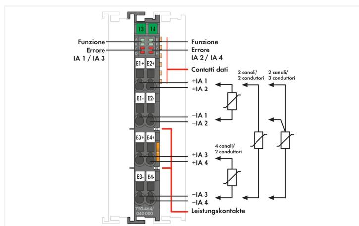
Questo modulo d'ingresso analogico collega direttamente i sensori di resistenza Pt o Ni e i potenziometri.
