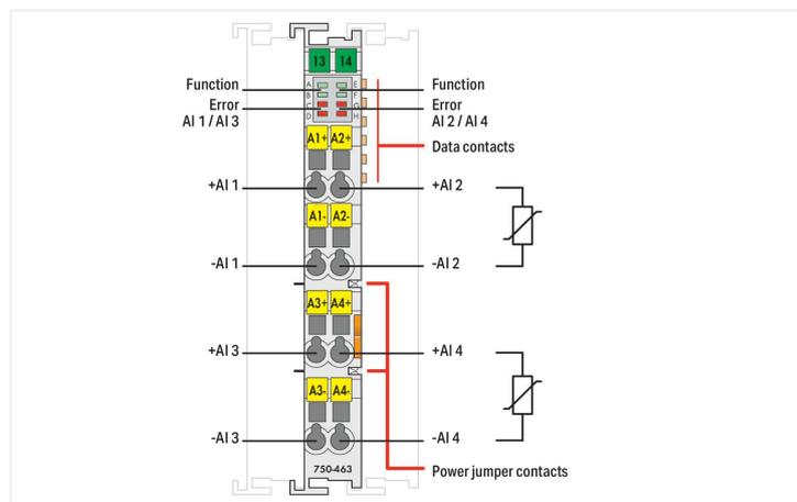
Questo modulo d'ingresso analogico si collega direttamente ai sensori di resistenza Pt o Ni selezionati.
