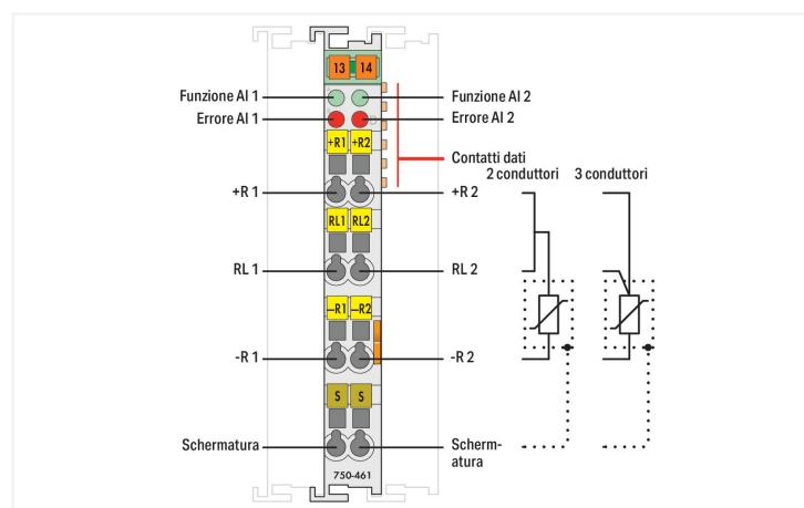
Questo modulo d'ingresso analogico si collega direttamente ai sensori di resistenza Pt.
