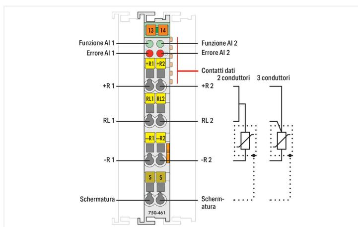
Questo modulo d'ingresso analogico si collega direttamente ai sensori di resistenza Pt o Ni.
