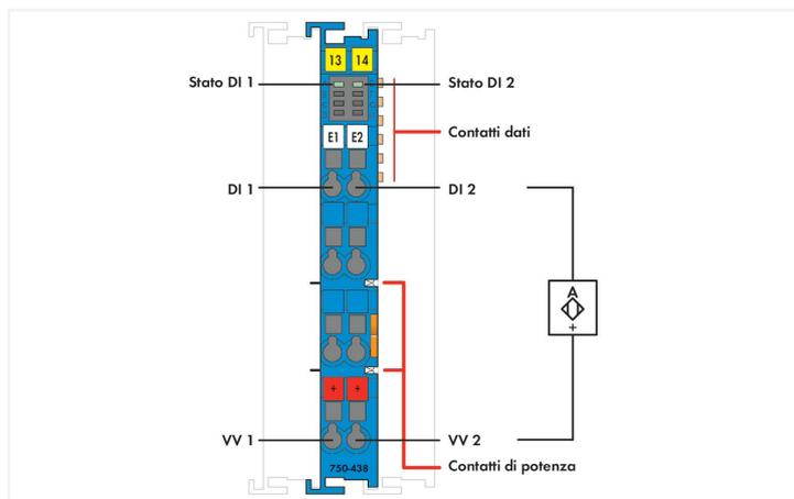
Questo modulo di ingresso digitale registra i segnali binari dai sensori impiegati nelle aree pericolose delle zone 0+1. Sensori NAMUR, optoaccoppiatori, contatti meccanici o altri elementi di azionamento possono anche essere connessi per mezzo di dispositivi a sicurezza intrinseca. Il WAGO-I/O System 750 deve essere installato nelle zone 2 o in ambienti non a rischio di esplosione. Ogni sensore è alimentato con una tensione da 8,2 V protetta dal corto circuito.
