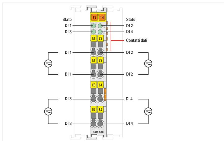
Questo modulo di ingresso digitale riceve i segnali di controllo dai dispositivi sul campo (ad es. sensori). Ogni modulo d'ingresso è dotato di un filtro per la soppressione dei disturbi con una costante di tempo. Campo e sistema sono separati galvanicamente. Tutti gli ingressi sono isolati.
