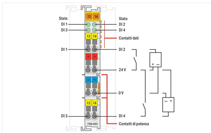
Questo modulo di ingresso digitale riceve i segnali di controllo dai dispositivi sul campo (ad es. sensori). Ogni modulo d'ingresso è dotato di un filtro per la soppressione dei disturbi con una costante di tempo. Campo e sistema sono separati galvanicamente. **Attenzione:** per l'alimentazione a 24 V AC deve essere montato un modulo di alimentazione supplementare!
