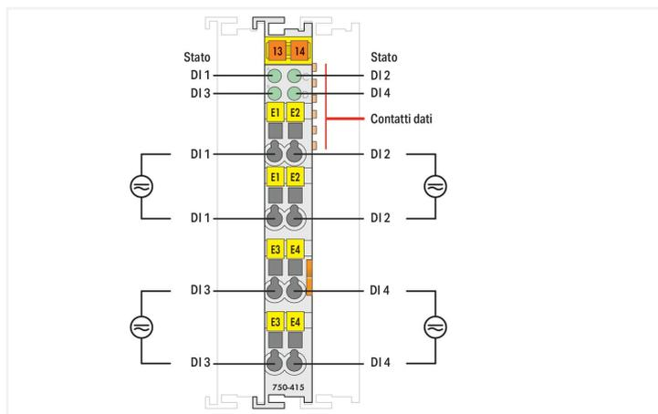
Questo modulo di ingresso digitale riceve i segnali di controllo dai dispositivi sul campo (ad es. sensori). Ogni ingresso dispone di un rettificatore a ponticello e di un capacitore e di una limitazione di corrente per il funzionamento AC/DC. Ogni modulo di ingresso è dotato di un filtro per la soppressione dei disturbi a valle con una costante di tempo integrata. Campo e sistema sono separati galvanicamente. Tutti gli ingressi sono isolati.
