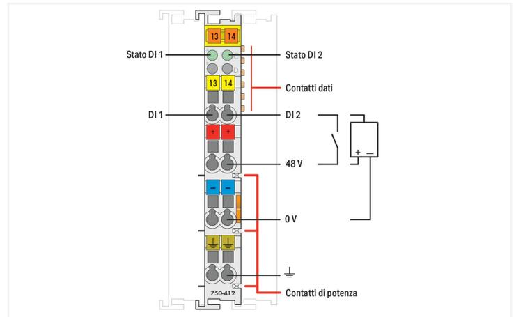
Questo modulo di ingresso digitale riceve i segnali di controllo dai dispositivi sul campo (ad es. sensori). Ogni modulo d'ingresso è dotato di un filtro per la soppressione dei disturbi con una costante di tempo. Campo e sistema sono separati galvanicamente. **Attenzione:** per l'alimentazione a 48 V DC deve essere montato un modulo di alimentazione supplementare!
