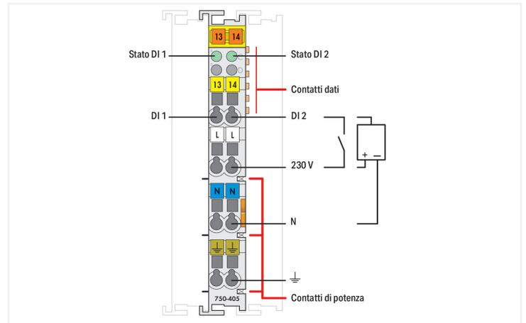
Questo modulo di ingresso digitale riceve i segnali di controllo dai dispositivi sul campo (ad es. sensori). Campo e sistema sono separati galvanicamente. **Attenzione:** per l'alimentazione a 230 V AC deve essere montato un modulo di alimentazione supplementare!
